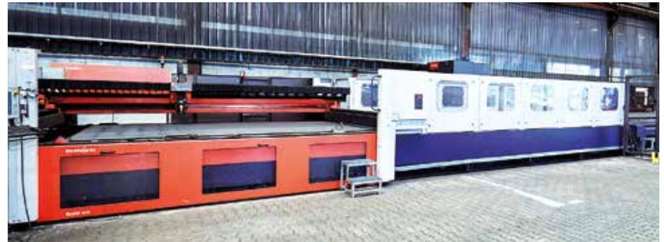
Instalación de corte por láser
