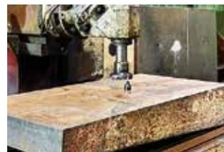
Determinación de la altura para el proceso de fresado
