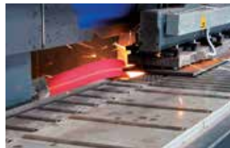
Fazowanie poprzez obróbkę
