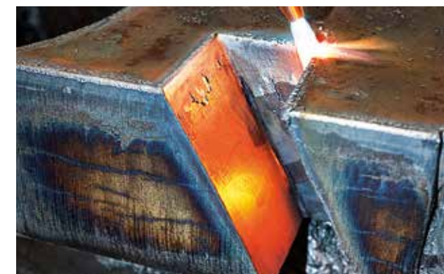
Pieza mecanizada con corte en chaflán
