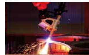
Robot d'oxycoupage/de découpe plasma
