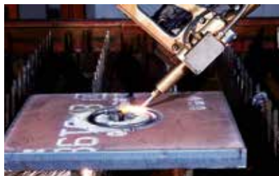
Chanfreinage par oxycoupage
