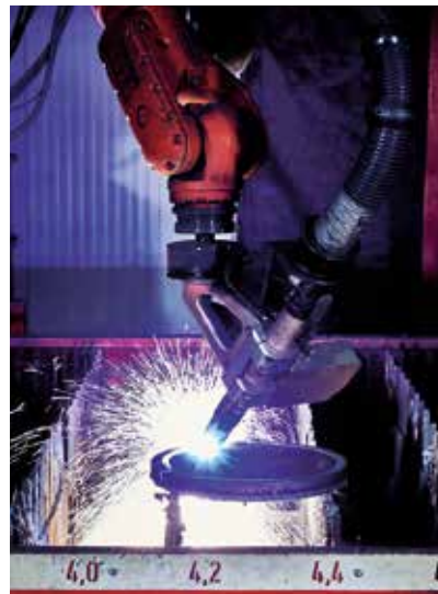
Chanfreinage par découpage plasma
